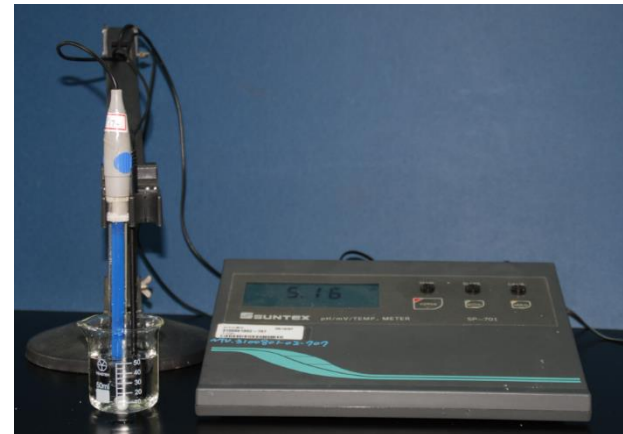
Fig. T16-1 pH meter in lab (SUNTEX SP-701)
